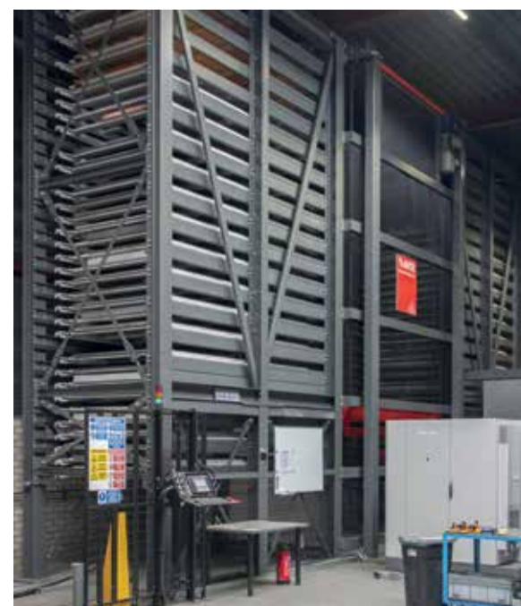
Het volledig geautomatiseerd beladingsstelsel van Antil kan 24/7 platen pakken, op de machine leggen en eraf halen.
